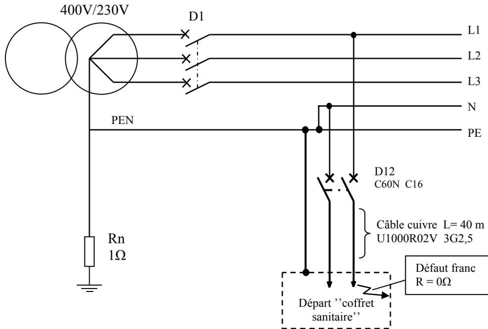
**B.1.4.** Sur le disjoncteur D12, on a relevé les indications suivantes : **C60N C16, 230V, 2 pôles.** Que signifie **C16** ?
