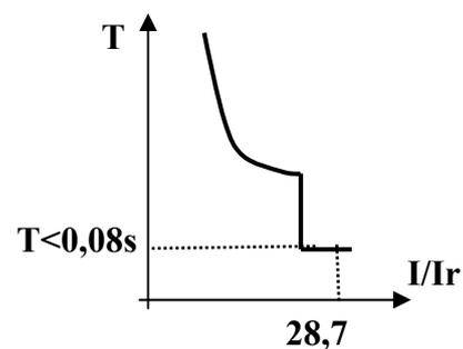
**Les deux disjoncteurs D1 et D10 déclencheront en même temps :. SELECTIVITE PARTIELLE**
